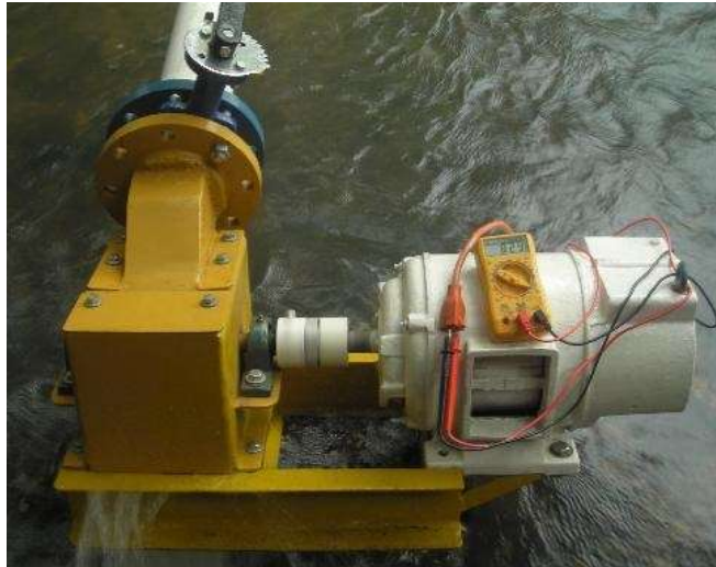
Foto 2.1 Generador de 1000 W con su Turbina "Crossflow"
