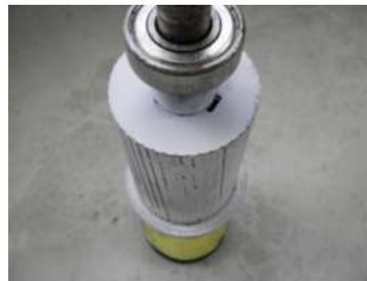
Foto 4.3 El rotor es preparado para recibir los imanes permanentes
