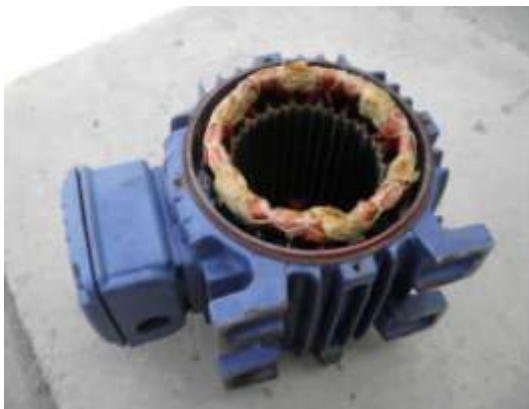
Foto 4.2 El estator sin el rotor
