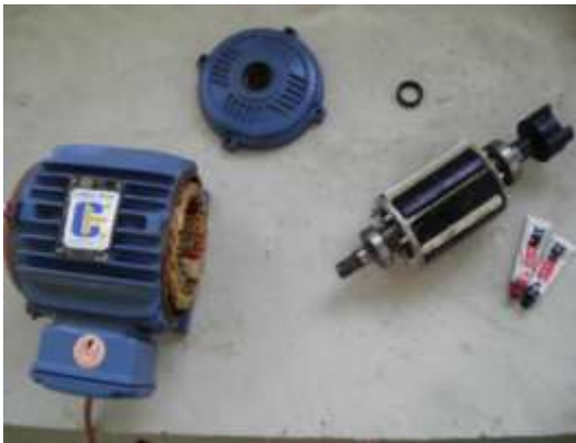
Foto 4.6 Se termina de colocar los 8 imanes, utilizando un pegamento de acero epóxico
