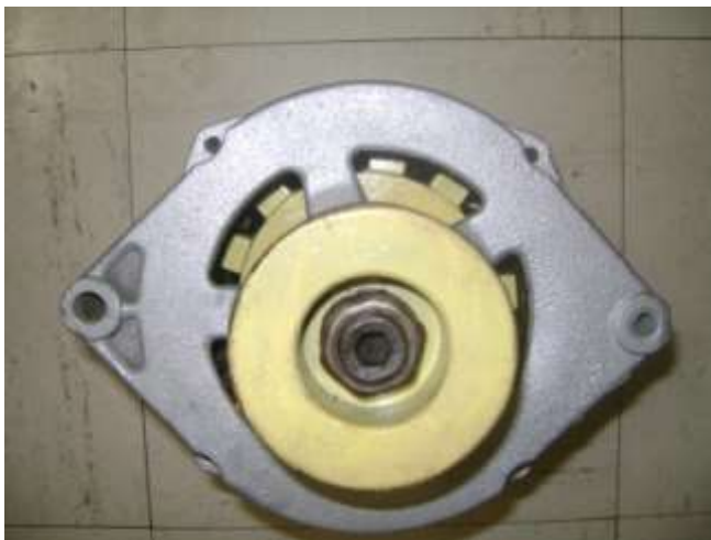
Foto 2.2 Generador de 500 W
