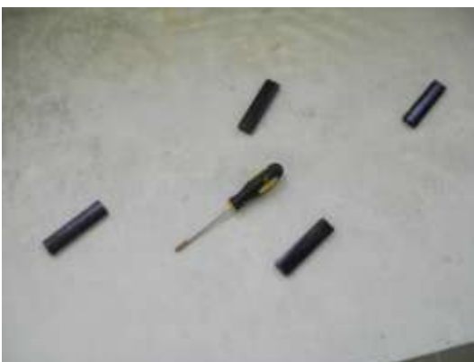
Foto 4.4 Se colocan los primeros cuatro imanes, se debe esperar un tiempo mínimo de 2 horas entre la colocación de un imán y otro para que el pegamento seque bien.
