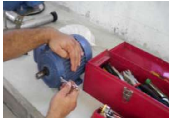
Foto 4.1 Una vez adquirido el nuevo motor se inicia su desarme y se retiran los tornillos y las tapas del estator
