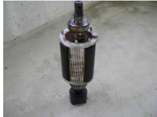
Foto 4.5 Los primeros 4 imanes colocados en su lugar en el rotor
