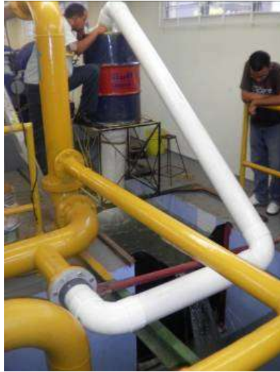
Foto 2.9 MHG 1000 en Sistema de Prueba
